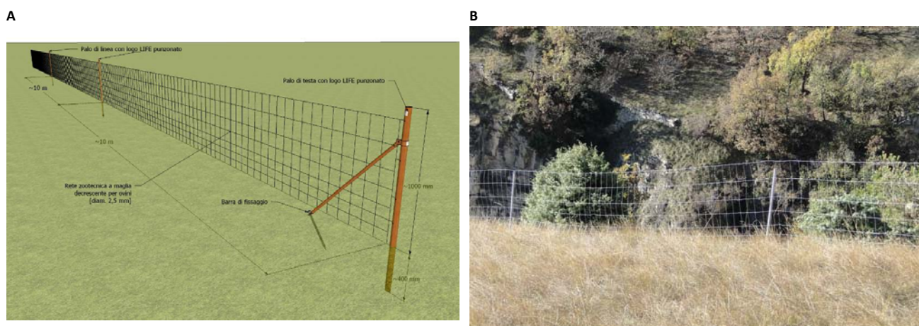
Figura 9. A) schema di installazione della recinzione a rete fissa in metallo a maglie decrescenti con angolo controventato come prevista nel progetto LIFE Xero-grazing; B) recinzione in opera.
